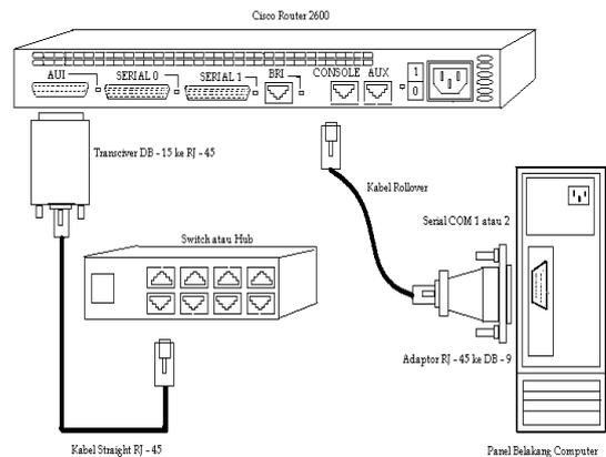
**Gambar 7 Koneksi Router ke Komputer dan Router ke Switch/Hub**
